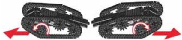
Рис. 3. Схема руху вперед гусеничного шасі
